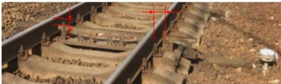
ნახ. 6 მოძრავი შემადგენლობის მსგელობისას გაბარიტის მაკონტროლებელი მოწყობილობების ძირითადი ნაწილი
