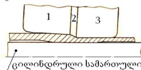
ნახ. 4. დეფორმაციის ზონები 3-გლინიან შემომგლინავ დგანებში
