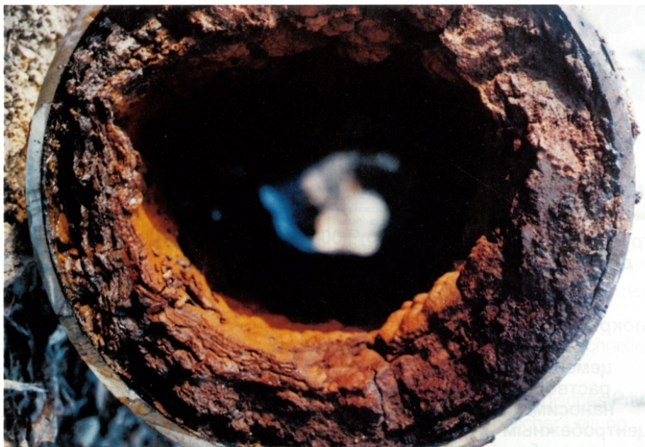
სურ. 1. ფოლადის წყალდენში რკინისა და მარგანეცის შემცველი წყლის მიერ მილის დიამეტრის d_1=300 მმ შემცირება 35-45%-ით, ხუთი წლის ექსპლუატაციის შემდეგ
