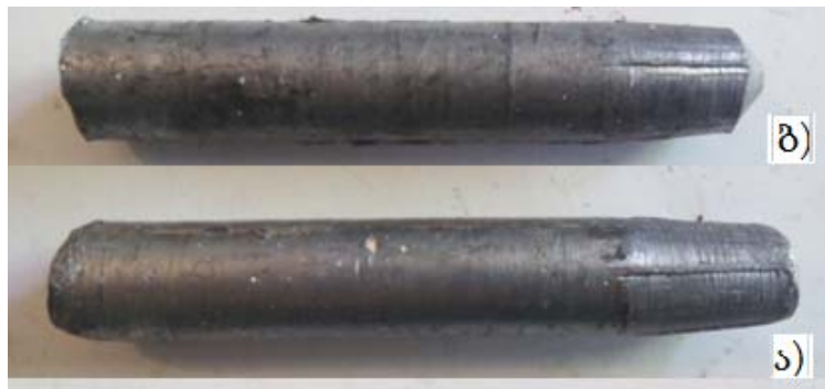
ნახ. 5. დეფორმირებული ნიმუშები: ა – D20; ბ – D24
