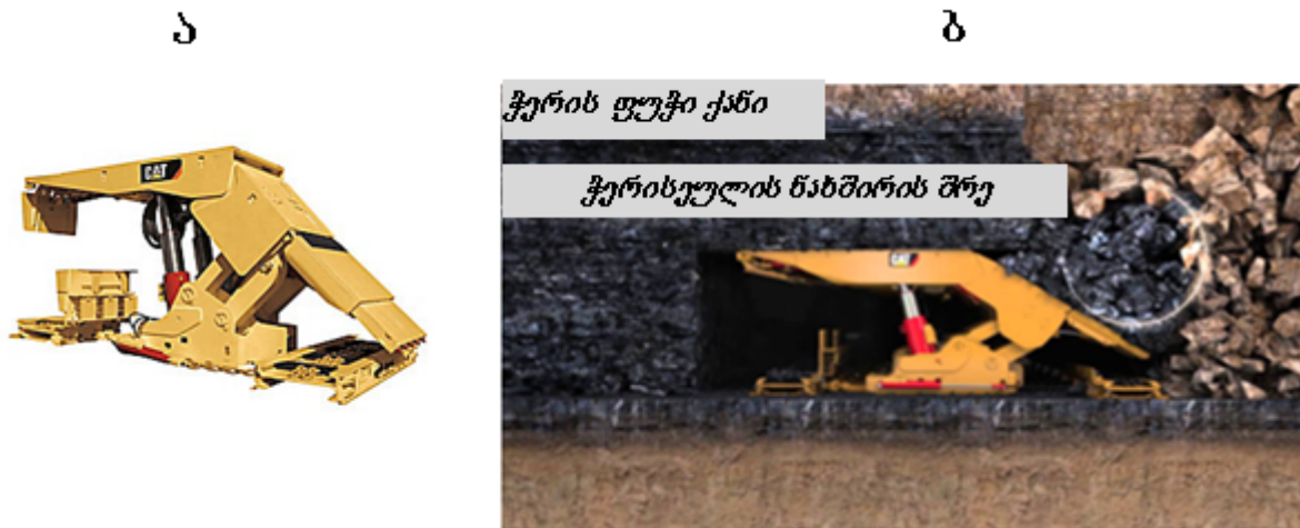
ნახ. 3. თანამედროვე მექანიზებული სამაგრის (ფირმა “Caterpillar”) სექცია (ა) და მისი გამოყენებით სქელი ფენის დამუშავების ტექნოლოგიური სქემა (ბ)
