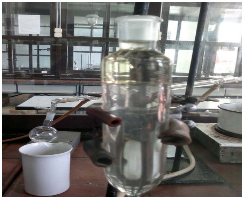
ნახ. 2. კოფეინის მისაღები ლაბორატორიული აპარატურა
